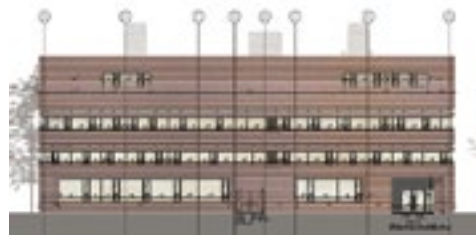
Ansicht Aussenfassade mit Kupferbändern
